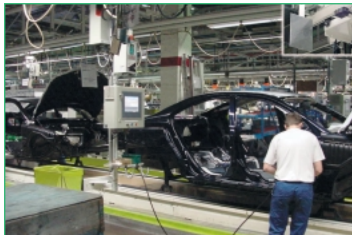
Vue d'un poste de travail équipé de l'HMI de Beckhoff, le module CX1000 intégré et le télémètre laser de Banner (coin supérieur droit de la photo) qui détermine la zone de travail.
