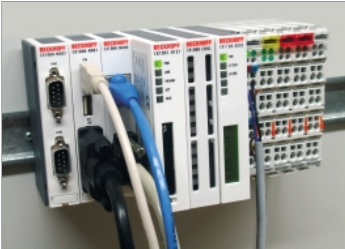
Close-up du module CX1000 chargé de la visualisation, de la communication et du traitement des données se rapportant au vissage par boulons.
